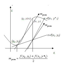
Observe que f(x0, y0) y f(x1, y\*1) son las pendientes de las rectas indicadas que pasan por los puntos (x0, y0) y (x1, y\*1), respectivamente.
